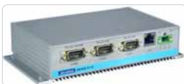
Obr. 3 Zabudované regulátory umožňujú automatizovať strojné zariadenia a priemyselné procesy v reálnom čase a zároveň môžu vystupovať v úlohe údajových koncentrátorov.
