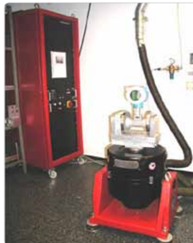
Obr. 2 Vírový prietokomer Prowirl v laboratóriu pri testovaní odolnosti proti vibráciám
